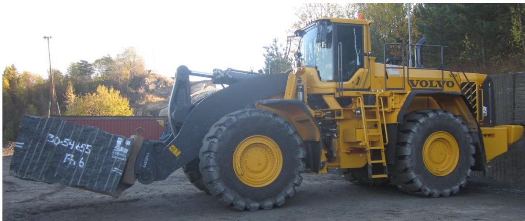
Figur 15: Hjullaster, VolvoL350F, 2013-mod. med gafler og en 17,6 tonn steinblokk.
